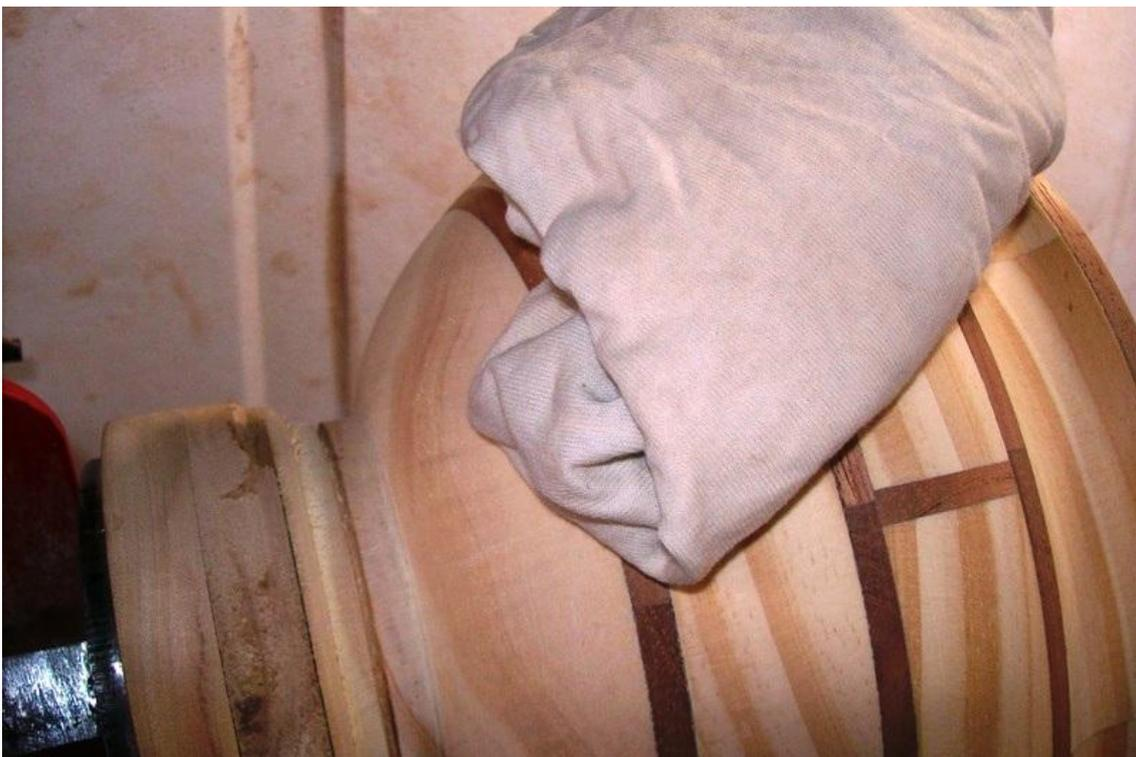
En este punto quedará a la vista cualquier detalle que antes se nos haya pasado por alto, tales como algún rayón, desnivel de la superficie, grieta, etc. Y es el momento para revisar detenidamente y hacer las correcciones necesarias antes de comenzar a aplicar el acabado. En este tipo de diseño de líneas simples, lo que primero llega a la vista es justamente la terminación, así que le dediqué un buen rato a revisar y arreglar.
