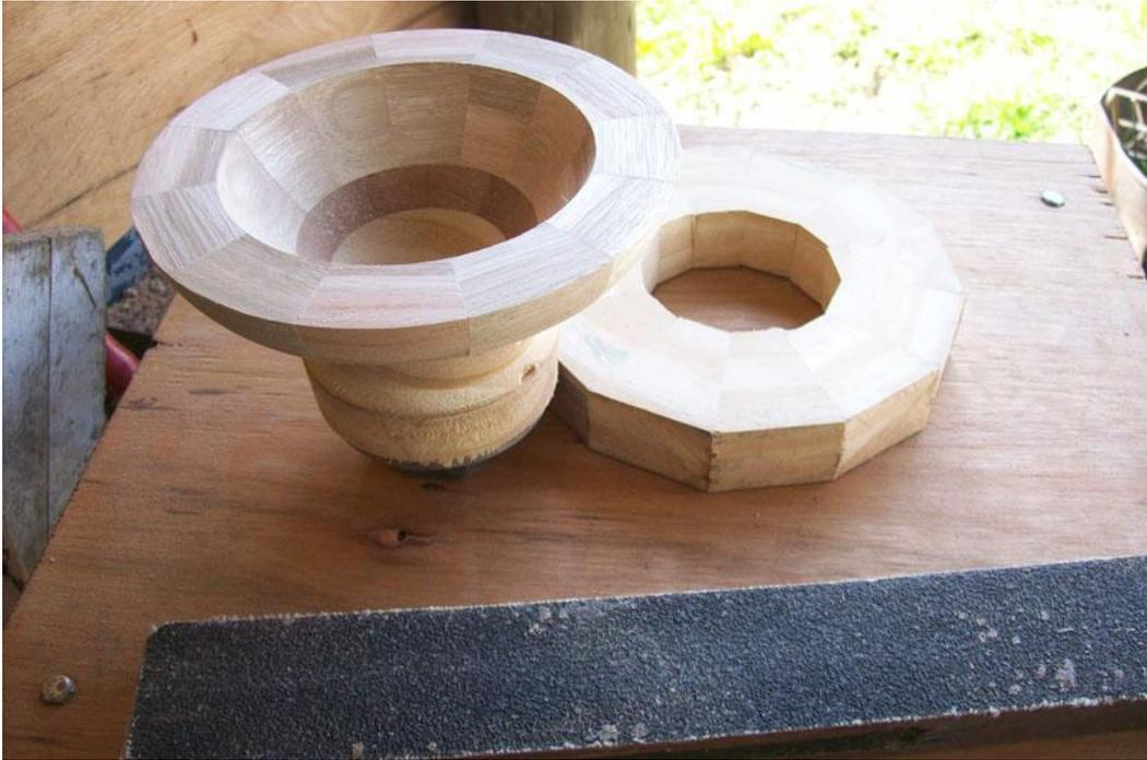
Torneado de la tapa y delineado del reborde de inserción. Es importante que este reborde quede bien escuadrado, y -obviamente- debe coincidir con la boca del cuerpo; es necesario tomar muy bien las medidas para no equivocarse, y detener el torno varias veces para ir probando el calce.
