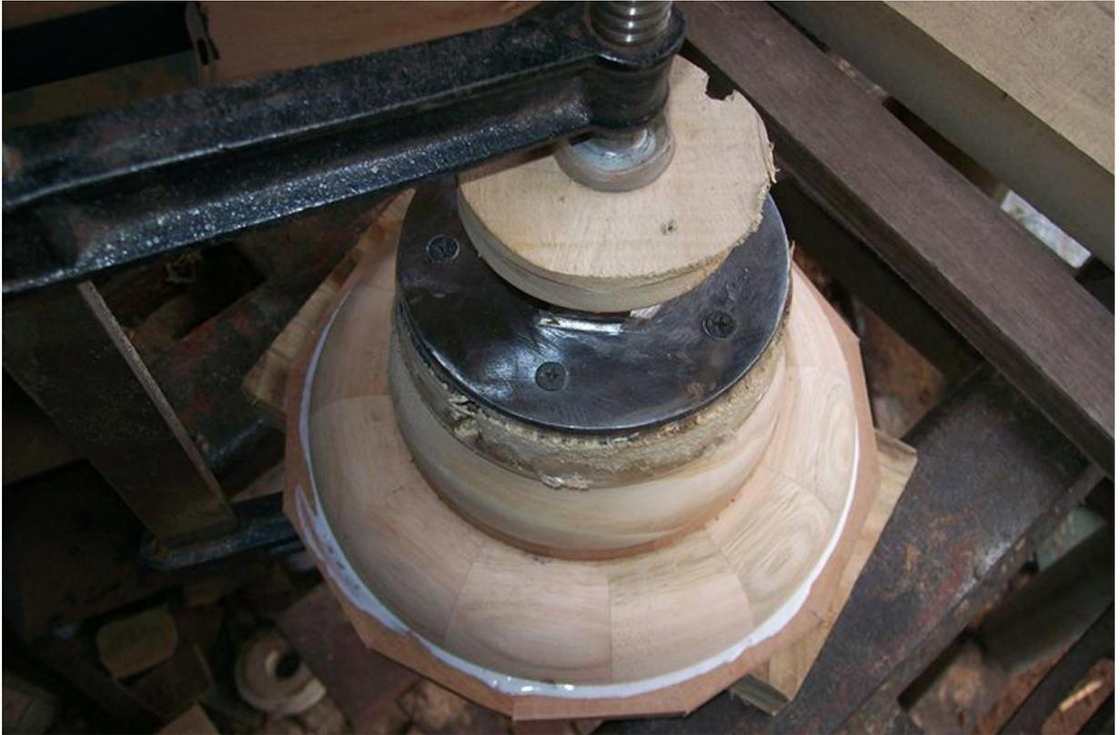
Torneado de la tercer corona, que ya queda preparada para agregarle la 4ta y última corona del cuerpo de la pieza, para luego pasar a la construcción de la tapa.
