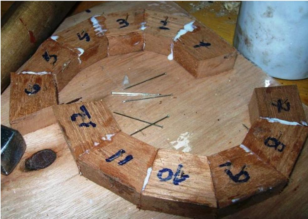
Continuando con la primera corona del cuerpo de la bombonera, una vez secas las dos semicoronas rectificó los extremos y encoló ambas. Ya agregada a la pieza y torneada, va quedando así:
