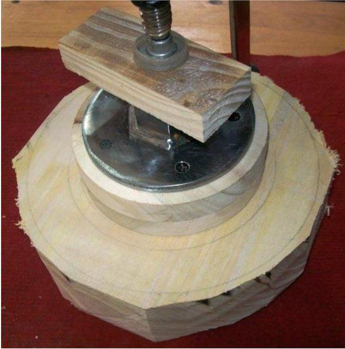
Ya seca la unión, se lleva a la máquina y comenzamos el torneado, con el esquema de la pieza en tamaño real siempre a mano, para ir verificando las medidas sin exceder el desbaste, y se empieza a dar forma, sin llegar todavía a las medidas definitivas. Vean que comencé a redondear el contorno y también excavar el interior.
