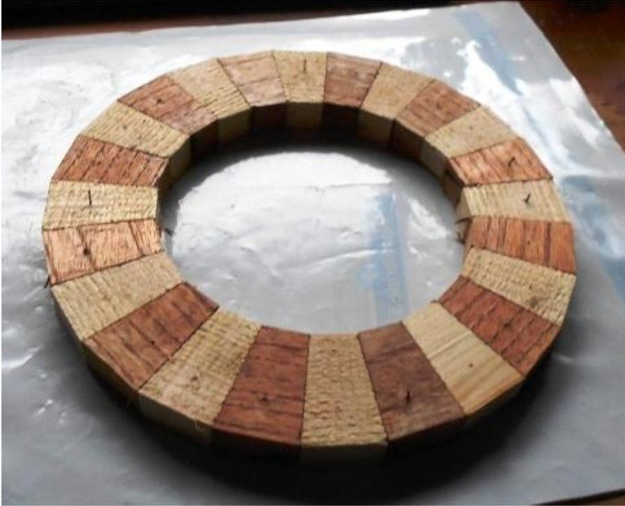
La figura 22 muestra ahora la corona con la cara buena hacia arriba sobre un tablero plano de MDF sujeto firmemente al banco de carpintero mediante sus "corchetes" ; se pueden ver dos alfileres que fijan la corona al tablero.
