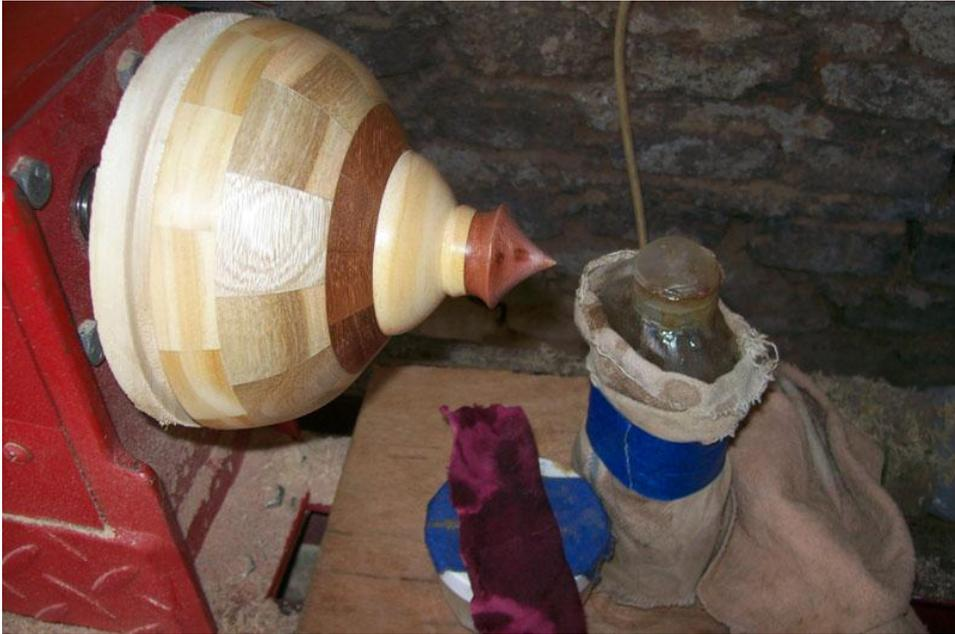
Con cuidado, le desbasté toda la pestaña al disco intermedio, hasta quedar al descubierto el reborde de la tapa. La tapa queda perfectamente sujeta por el encolado al disco con cartón
