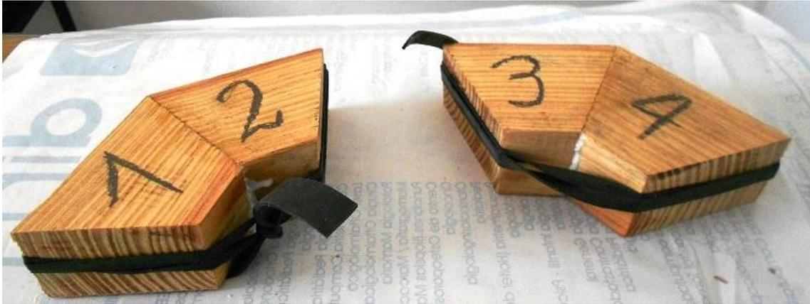
Una vez secos los pares tienen que encolar las dos semicoronas prensándolas con tiras de goma, envolviendo la cara perimetral del octógono y separando las semicoronas con cilindros de poco diámetro (pueden ser dos tarugos finos, por ejemplo) ; por supuesto previamente hay que rectificar solo las caras que tienen que unir controlando con una regla.
