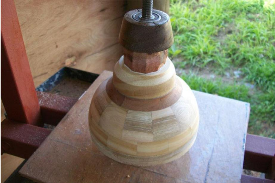
Llevé la pieza al torno y di forma a la parte superior de la caja y su remate
