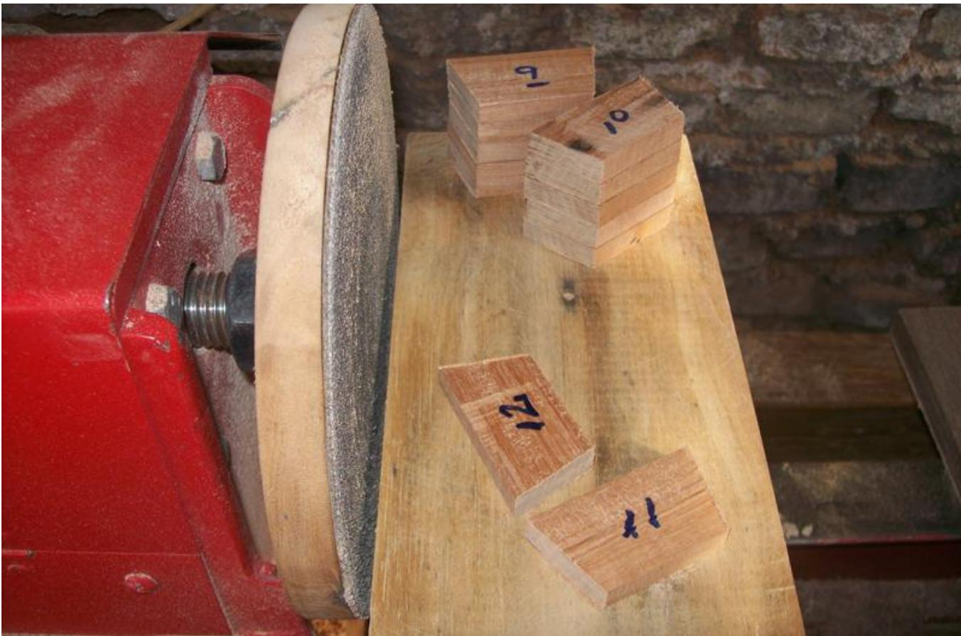
En esta foto se puede ver como va quedando mi bombonera, con la 1ra y 2da corona prácticamente terminadas de tornear. Aún me falta afinar un poco la base, pero siempre prefiero dejar este paso para el final, porque me da más seguridad que la pieza tenga una gran superficie de contacto con el disco intermedio.
